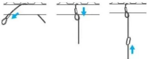
sac de 100 crochets de fixation sans cheville en inox pour dalle béton pleine ou alvéolaire - charge de travail 45 kg
