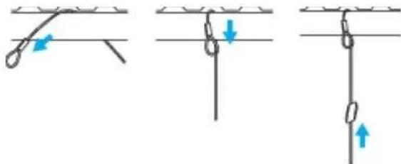
suspension rapide 5 m 45 kg embout boucle - pour suspension des réseaux aérauliques, circulaire, oblong et rectangulaire mais aussi des petits ventilateurs, ventilo-convecteurs ou des plénums + diffuseurs
