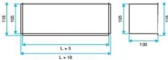
la grille gridlined® est une grille de transfert avec une largeur de 200 mm et une hauteur de 410 mm parfaitement adaptée pour assurer le transfert de l'air entre 2 zones séparées par une porte où le détalonnage serait insuffisant.
