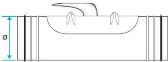
raccord mâle à joints avec trappe de visite intégrée -
