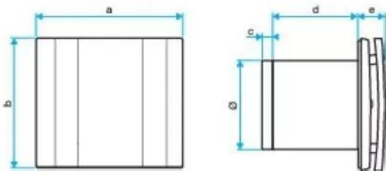
extracteur ponctuel deco aluminium  $\varnothing$  100 mm h avec marche / arrêt à détection d'humidité avec minuterie réglable. applicable en cuisine ou grande salle de bain.
