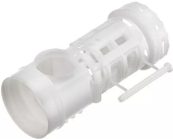
Boite de banche pour mur béton banché Maxibanche SP pour gaine de Ø40 pour installation spécifique type passage de gaine HDMI, alimentation générale du tableau, plomberie avec structure tubulaire et goupille de sécurité des Maxibanches
