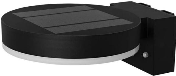
ledvance applique solaire endura solar circle gris - diffuseur pc - 6w/3000k - détecteur de présence et luminosté - 3 modes (75/400/600lm) - batterie : fonctionnement et charge : 8h - ip44 - 188x158x70mm (lxh) - garantie 5 ans.
