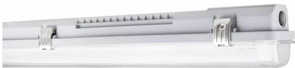
ledvance etanche vide 0,60m en polycarbonate de classe i pour 1 tube led. protection ip65/ik08. etriers et clips en inox, bornier automatique avec repiquage. dimensions : 685x65x70mm. uniquement pour tubes à led en 230v. garantie 5 ans
