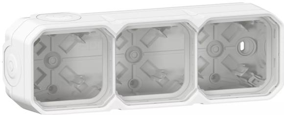
boîtier saillie étanche plexo 3 postes pour montage horizontal ou vertical, sans cloison, avec 4 embouts à membrane amovible et perforable sans découpe 1 entrée et 1 embout 2 entrées - blanc
