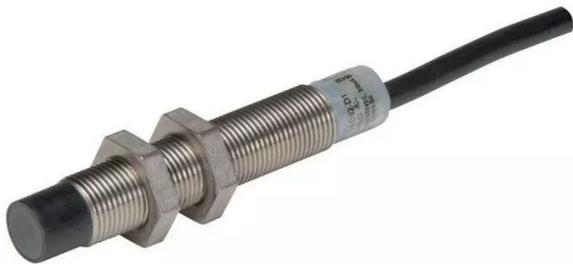
Détecteur de proximité, inductif, 1 O, Sn=8mm, 2L, 40-250VAC, 20-250VDC, M18, métal, câble 2m
