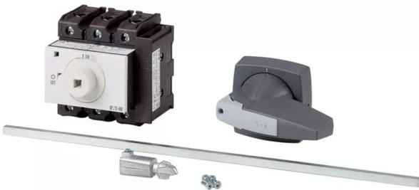
Interrupteur général, tripolaire + 1 Contact F + 1 Contact O, 100 A, Fonction d'arrêt d'urgence, verrouillable en position 0, Encastrement / Montage encastré avec fixation arrière, avec axe métallique de 400 mm
