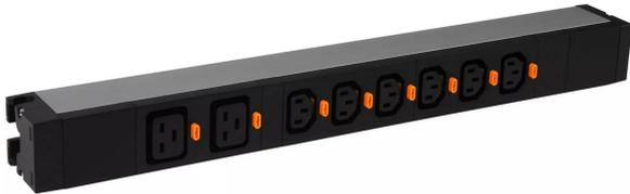
pdu standard 19pouces 1u lcs<sup>3</sup> avec 6 prises c13 et 2 prises c19 verrouillables et raccordement par bornier - cuve aluminium avec fixation rapide sans vis - livré avec embouts avec équerres métalliques 180°
