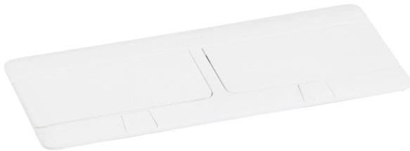
pop up à encastrer dans mobilier 2x4 modules pré-câblé, livré avec 2 prises 2p+t avec cordon et fiche 2p+t longueur 2m, 2 prises rj45 catégorie 6 ftp , 1 prise hd15 et 1 prise jack 3,5mm - blanc brillant
