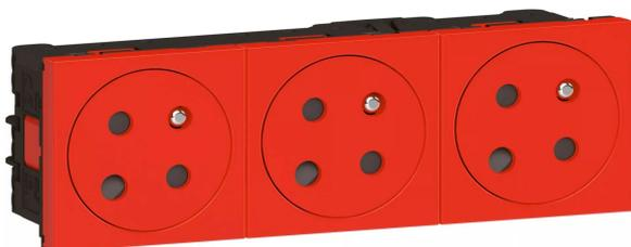
triple prise de courant 2p+t surface mosaic link à puits incliné à 45° à raccordement latéral par bornes automatiques à levier 6 modules finition rouge - à équiper d'un support et d'une plaque mosaic
